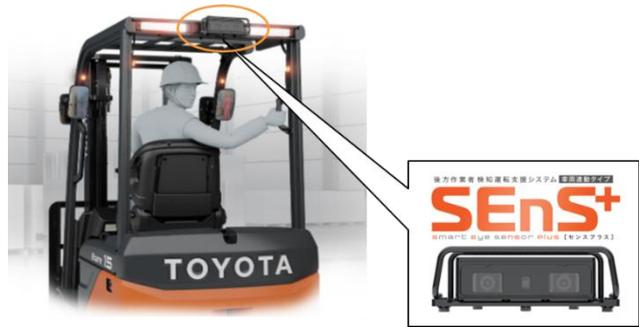
図4 後方作業者検知運転支援システム“SEnS+”
